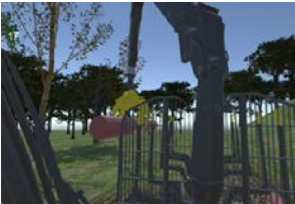
Рис. 6. Тренажер для подготовки операторов транспортно-технологических машин. Момент захвата сортимента в трехмерном пространстве
