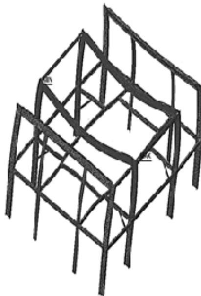
Рис. 3. Относительная деформация каркаса основания
