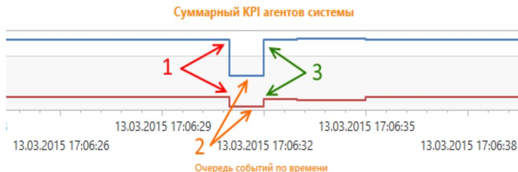
Рис. 1. График состояний прототипа системы планирования при вводе события выхода из строя ресурса, участвующего в планировании (техническое средство ОКИК): 1 – ввод события о выходе из строя тех. средства; 2 – скачкообразное достижение локального минимума удовлетворенности агентов; 3 – восстановление расписания при новых условиях
