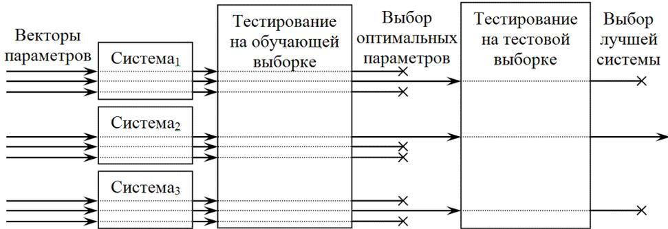
Рис. 1. Схема отбора систем и параметров при традиционном подходе
