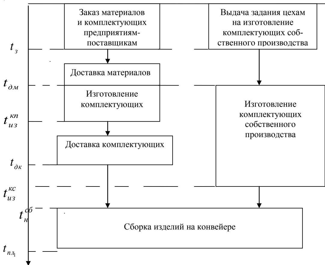
Рис. 1. Укрупненный технологический цикл изготовления планового объема изделий V_{пл} с временной привязкой производственных операций
