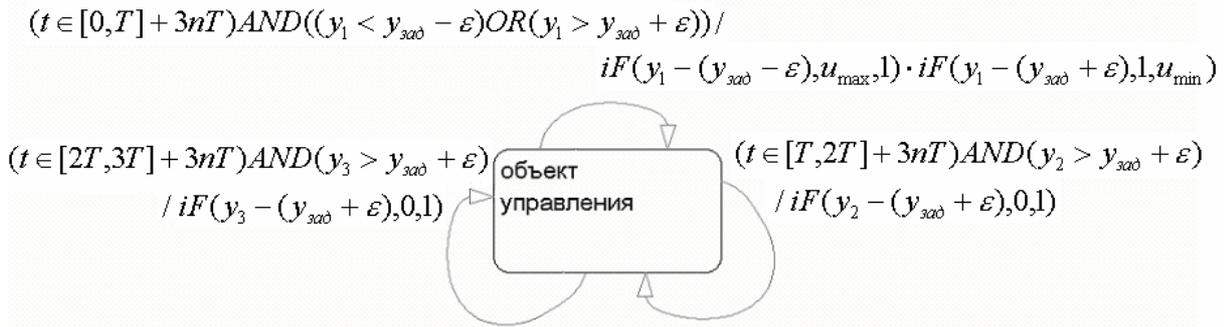
Р и с. 7. Гибридно-автоматная модель системы управления индукционной пайкой тонкостенных оболочек
