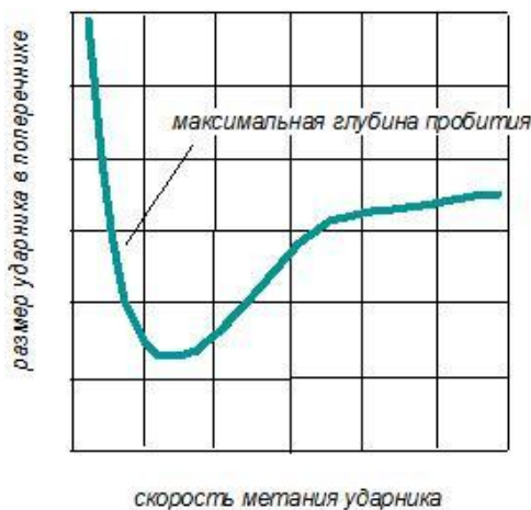
Рис. 4. Зависимость максимальной глубины пробития от диаметра ударника
