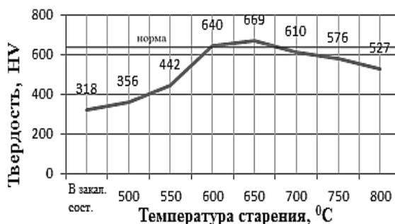
Р и с. 3. График зависимости твердости от температуры дисперсионного твердения с выдержкой 5 часов
