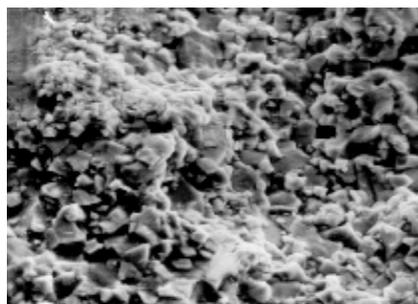
Р и с. 6. Фрактография излома зубка из сплава ВК13 с минимальной циклической стойкостью, соответствующей 49 ударам ( $\times 4000$ )
