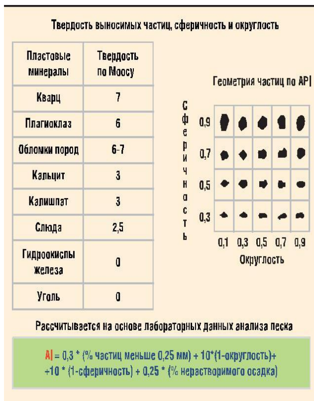
Рис. 1. Диаграмма для визуального определения округлости частиц
