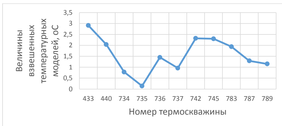
Рис. 3. График с величинами взвешенных температурных моделей термоскважин на выбранном участке трассы магистрального нефтепровода
