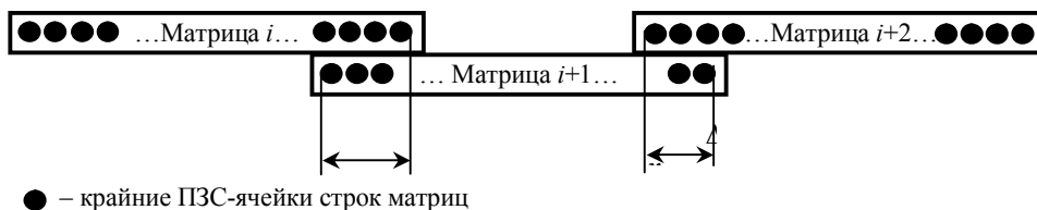
Рис. 1. Взаимное расположение ПЗС-матриц в фокальной плоскости ОС
