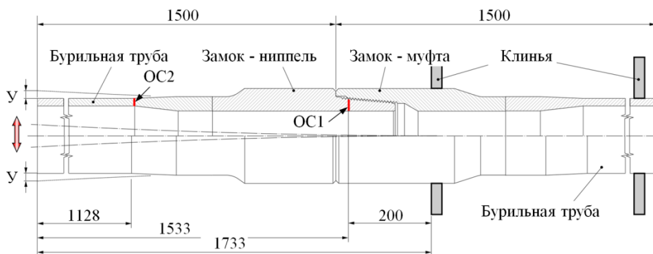
Рис. 4. Схема нагружения испытуемого образца
