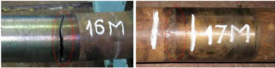
Рис. 8. Разрушение образцов 16М и 17М по зоне контакта токосъема наплавочной машины
