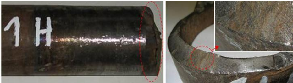
Рис. 9. Разрушение образца 1Н бурильной трубы ПК 127×9 «Д» с приваренным замком ЗП-162-95-2 по дефекту в теле трубы
