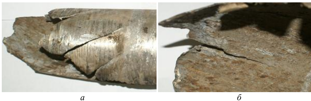
Рис. 1. Области разрушения ЛБТ, \times 0,3 : а – наружная поверхность; б – внутренняя поверхность
