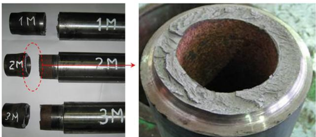
Рис. 3. Образцы труб ПН 89×9 после испытаний на растяжение и характерный вид слома
