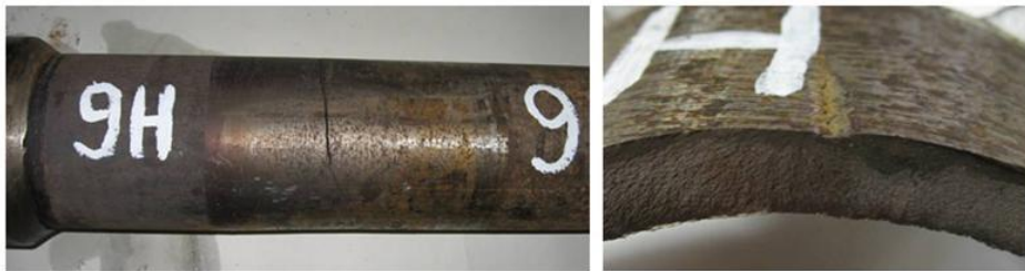
Рис. 10. Разрушение образца 9Н бурильной трубы ПК 127×9 «Д» с приваренным замком ЗП-162-95-2 по дефекту в теле трубы при испытании на усталость на стенде СТ-20
