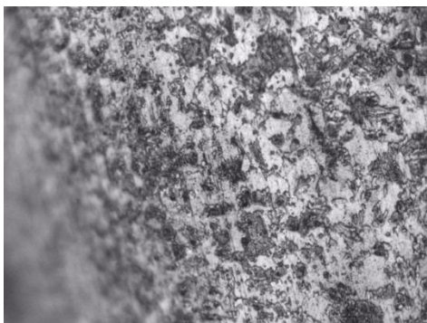
Рис. 1. Микроструктура исходного материала – феррит + перлит, увеличение X1000
