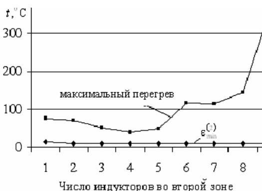
Р и с. 6. Зависимости минимакса  $\epsilon_{\min}^{(2)}$  и максимального перегрева  $\theta_{\max} - \theta^*$  от числа индукторов во второй секции при 100% производительности
