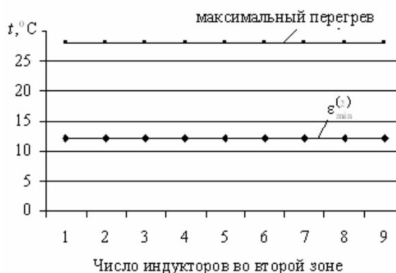
Р и с. 7. Зависимости минимакса  $\epsilon_{\min}^{(2)}$  и максимального перегрева  $\theta_{\max} - \theta^*$  от числа индукторов во второй секции при 30% производительности
