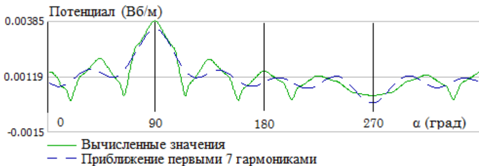
Рис. 2. Кривая магнитного потенциала на поверхности ротора
