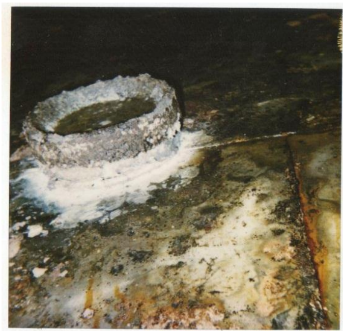
Рис. 3. Принцип растворения протектора ПРМ-20
