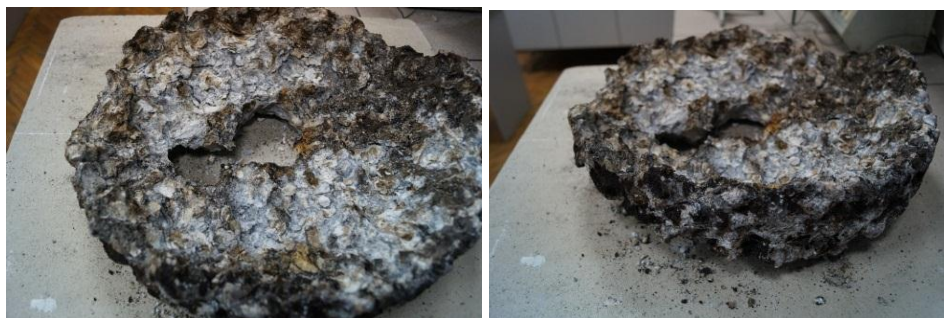
Рис. 2. Общий вид протектора после пяти лет эксплуатации
