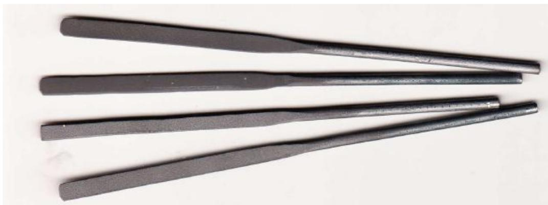
Рис. 3. Образцы надфилей с абразивным твердым покрытием
