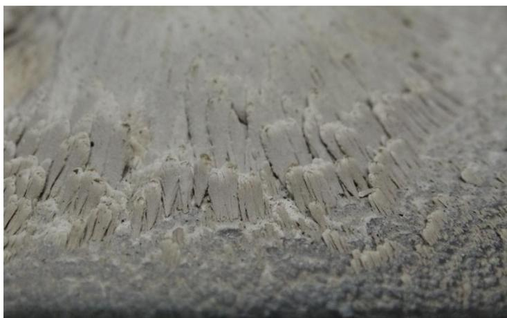
Рис. 2. Монокристаллы корунда в виде зубьев, сформированные при напылении керамического покрытия. Видна ориентация кристаллов в направлении потока напыляемых частиц
