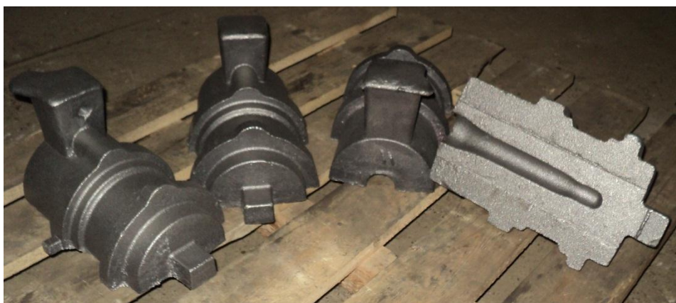
Рис. 2. Литые заготовки стеклоформ с прибылями
