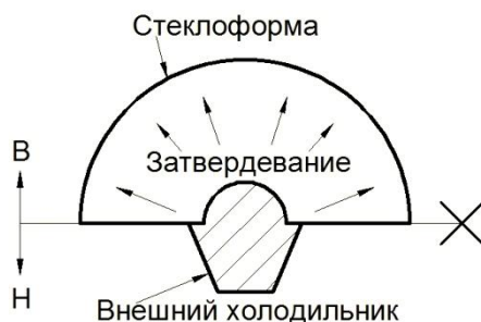
Рис. 1. Технология изготовления литых заготовок стеклоформ
