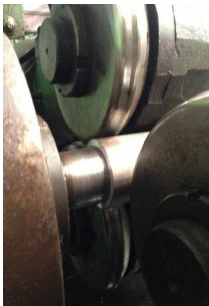
Рис. 1. Обкатывание трубной заготовки роликами
