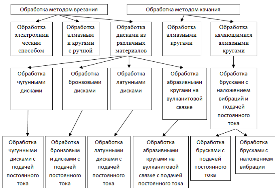
Рис. 1. Классификация способов обработки поверхности АПР
