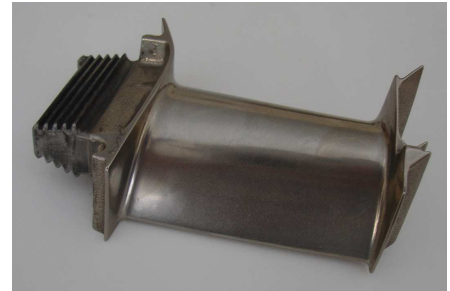
Р и с. 10. Лопатка 1 ступени турбины авиационного двигателя, профиль поверхности полирован на виброконтактном станке ЛВП-4
